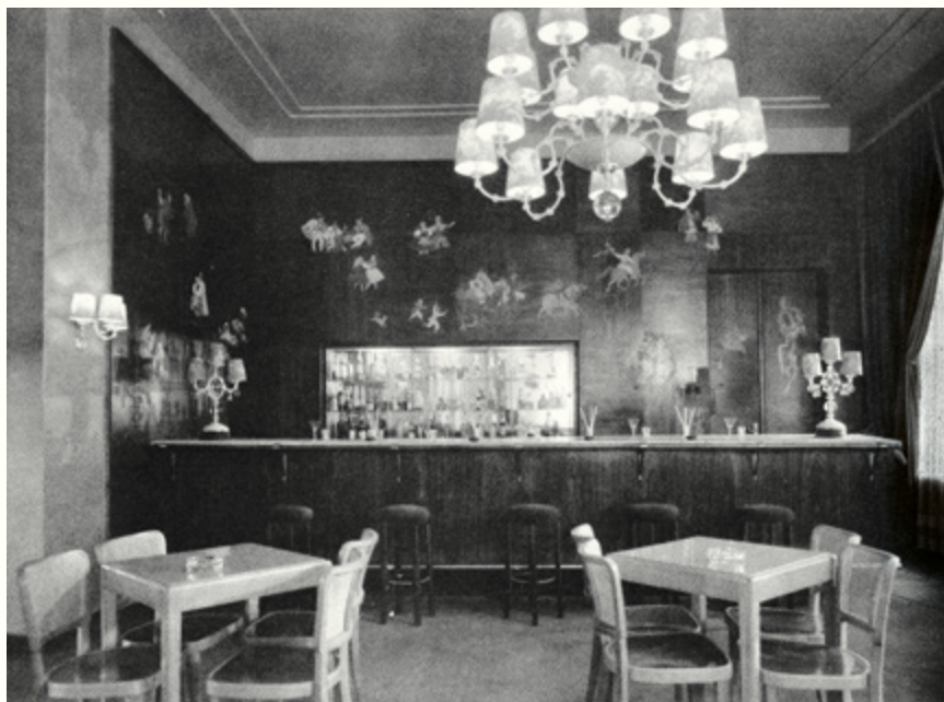
Kasyno w Warszawie według projektu Hansa Pfanna i Richarda Weißego, 1942. Ilustrację w czasopiśmie „Moderne Bauformen” opatrzone podpisem: „Bar-bufet obok wielkiej sali. Ściany wyłożono złotą tapetą tekko. Boazeria z tyłu i obok lady wykonana jest z bejcowanego na czarno drewna, znalazły się na niej barwne sceny figuralne z życia ludu, wykonane przez panie Wajwód i Manteuffel. Oświetlenie kremowe, abażury z chintzu w czerwone i żółte wzory, zasłony z jasnozielonego aksamitu”
